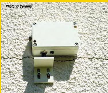
▲ Deux fissuromètres ont été mis en place pour suivre les fissures et les désordres.
