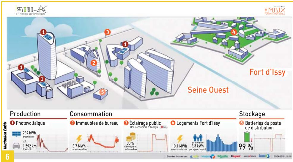
6 La société Embix a développé le système graphique de restitution du fonctionnement global du smart grid IssyGrid. Sous forme de plusieurs tableaux de bord, il fournit une information synthétique sur le fonctionnement d'IssyGrid, compréhensible pour les non-spécialistes.
