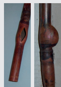
Hernie et déchirure de tube cuivre
