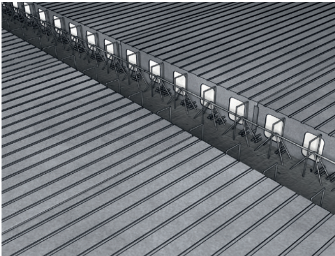
Figure 11 : Détail sur appuis des éléments porteurs de type D avant clavetage
