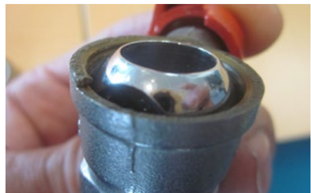
19. Rupture d'une vanne à boisseau sphérique. (Crédit photo : Eurisk)
