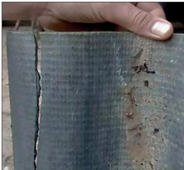
Sériel des plaques fibres-ciment sans amiante apparu en France à partir de 2002, provoquant l'apparition de fissures ou de fractures généralement en sommet d'onde au droit des fixations des plaques. En cause : le process de fabrication, et plus précisément la carbonatation de la matrice ciment et une porosité excessive des plaques.
