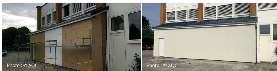
Figure 1 : illustrations du banc d'essai. De gauche à droite : schéma des trois zones d'isolants, isolants du banc avant application d'enduit*, banc fini avec isolants et enduit appliqué.
