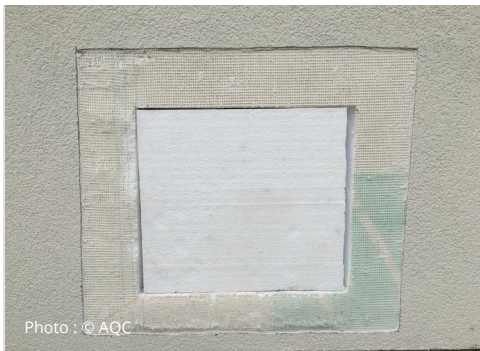
Figure 3 : illustration de prélèvements et des éprouvettes de trois couples isolant/enduit
