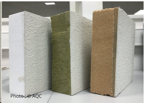
Figure 3 : illustration de prélèvements et des éprouvettes de trois couples isolant/enduit
