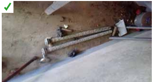
Les anodes sacrificielles en magnésium ont été remplacées suivant le planning d'entretien prévu. Ce remplacement est intervenu avant qu'elles ne soient trop abîmées et que la corrosion galvanique n'attaque la cuve en acier inoxydable. ©AQC
