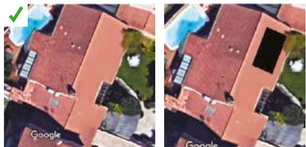
Exemple d'insertion (rectangle noir) d'une installation photovoltaïque sur une ortophotographie (source Google Maps). Cette insertion a été ajoutée comme pièce complémentaire lors de la déclaration préalable. ©AQC
