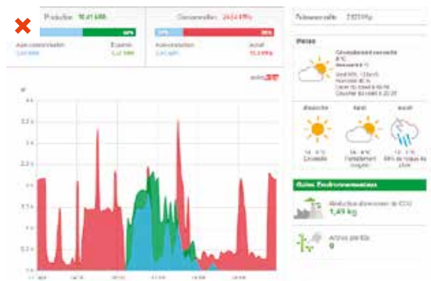
La courbe de charge (rouge) n'est pas optimisée. Le taux d'autoconsommation (bleu) est de 56%, la production restante (aire verte) (44%) est vendue au réseau. ©AQC
