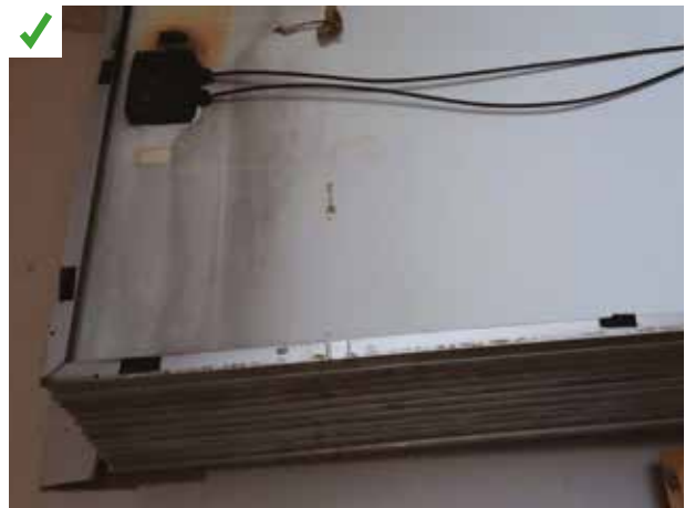
Un endroit spécifique a été prévu pour le stockage des panneaux défectueux avant leur dépôt dans un point de collecte. ©AQC
