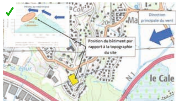
Plan de localisation permettant d'appréhender le positionnement de l'ouvrage dans le relief et son orientation aux vents. ©Watt Smart
