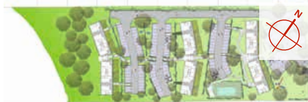
Les bâtiments sont éloignés entre eux par les espaces de stationnement d'une distance équivalente à 5 fois leur hauteur ce qui permet de se prémunir de l'effet de sillage et de bénéficier d'une ventilation naturelle efficace. ©AQC
