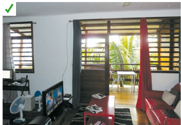
Salon et chambre déplacés du côté jardin lors de la réhabilitation limitant ainsi la perception des bruits de la rue. ©AQC
