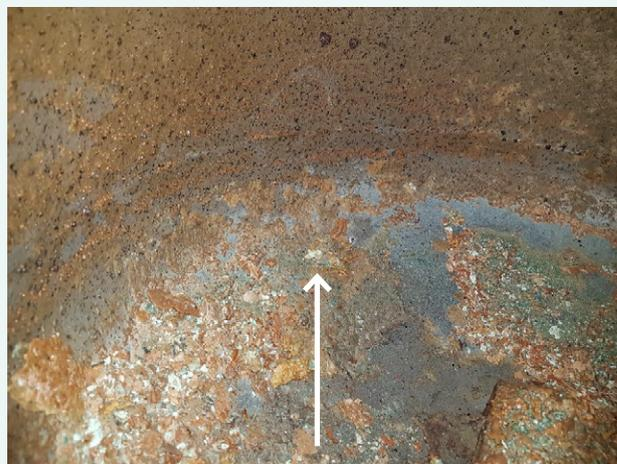
Dépôts de produits de corrosion en fond de ballon
