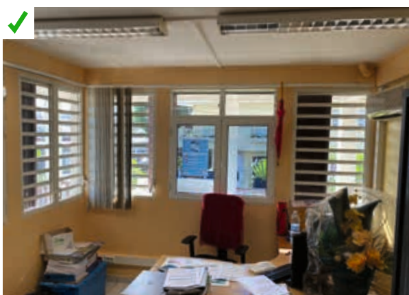
Nombreuses ouvertures sur des façades différentes permettant d'avoir une vue sur l'extérieur, d'assurer une ventilation traversante et d'optimiser l'éclairage naturel. ©AQC
