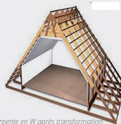
Charpente en W après transformation
