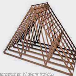
Charpente en W avant travaux
